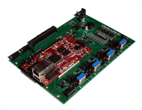
Figure 3.1: CAN-BENCH Carrier Card
